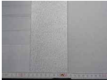
Deckbeschichtung in weißaluminium RAL 9006 (links gestrichen, Mitte gerollt, rechts gespritzt). © GEHOLIT + WIEMER
