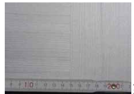
Deckbeschichtung in weißaluminium RAL 9006 (gestrichen). © GEHOLIT + WIEMER
